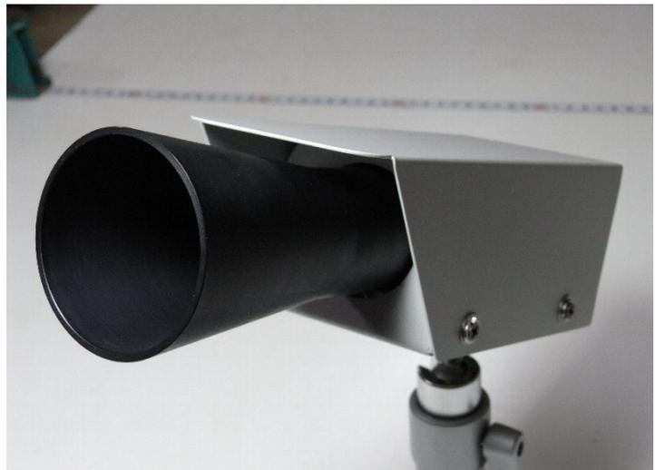
同じくOM5タイプにひさし付のフィルターホーンOM-FH1を装着してセンサカバーに収納です。ダブルのひさし効果はいかほどか？安心感が増します。
